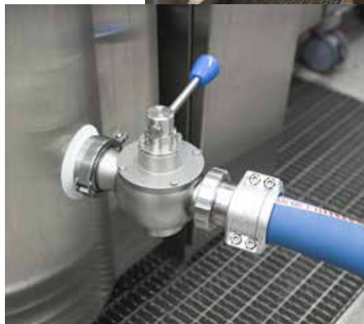
DOS 2-stasjon med doserings­slange og poseforsegler som tilbehør.
