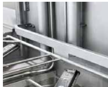
Som standard har maskinen en kurvstøtte i bakkant sammen med den fastmonterte kurvbanen.
