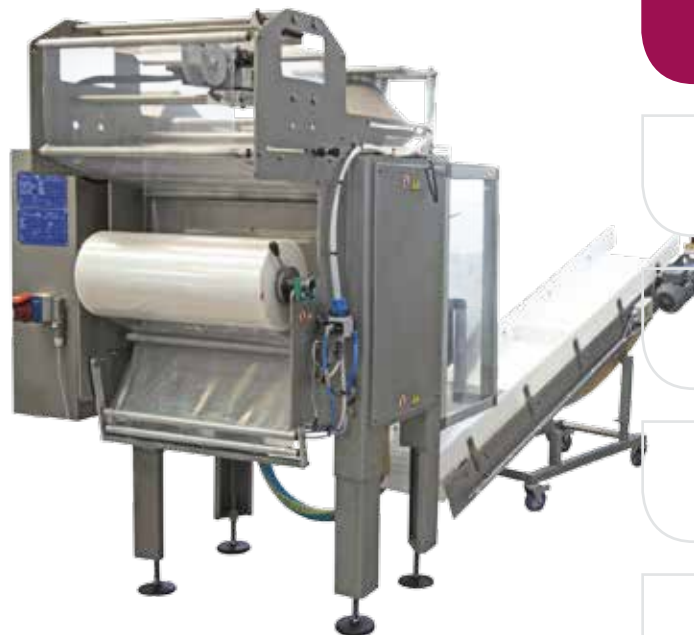
HOT-FILL DOS 3 helautomatisk dosering og pakking
