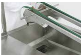
Bassenget har en åpen konstruksjon som gjør at det er lett å rengjøre. Transportørbandet kan tas av hvis nødvendig.
