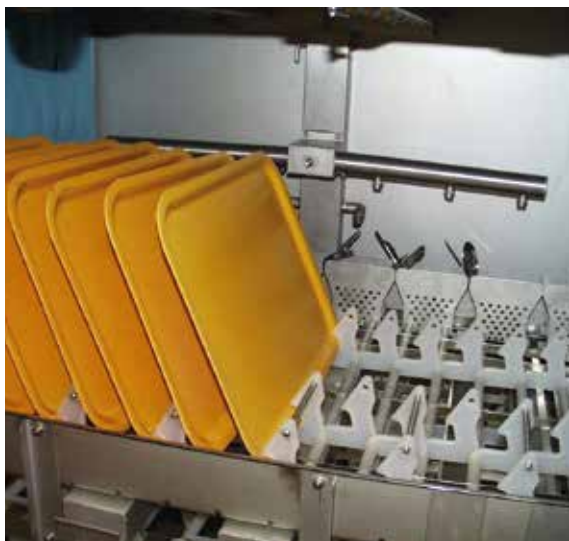
WD-66CT brett- og bestikkoppvaskmaskin vasker både brett og bestikk i den samme maskinen.
