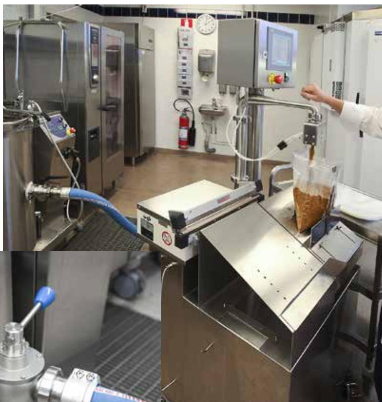
DOS 2-stasjon med doserings­slange og poseforsegler som tilbehør.
