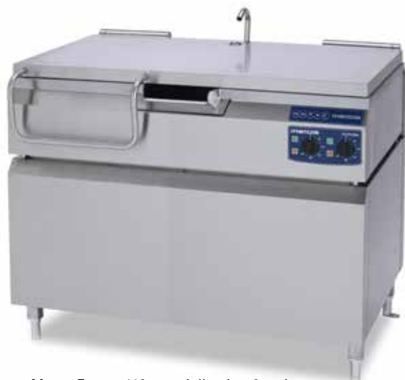
Metos Futura 110 - modellen har 2 stekesoner, pannedybde 90 eller 180 mm.
