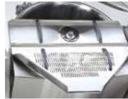
Todelt silplate (300-400 l). Tilleggsdel brukes om det er nødvendig.
